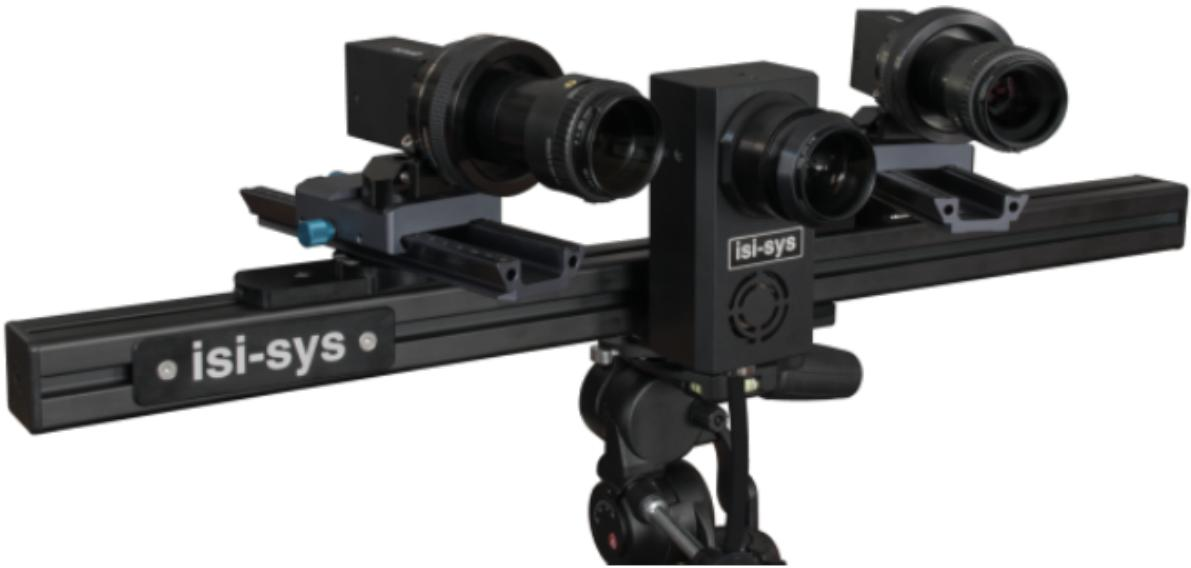
模态分析是结构力学特性研究及设备故障诊断的重要方法。通过模态分析结构物在某一易受影响的频率范围内各阶主要模态特性，预估结构在内外振源作用下产生的实际振动响应，为结构物的振动特性分析、振动故障诊断和预报、结构动力特性的优化设计提供重要依据。光学应变测量系统振动模态功能可测量分析出结构运行过程中的多阶固有频率、阻尼比和各阶振型，而被较多应用于航天航空、汽车、船舶、土木建筑等领域，为研究各类振动特性提供了一种可视化、非接触式的测量分析方法。
